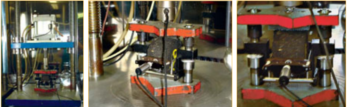
Figura 3 – Ensaio de módulo de resiliência por compressão diametral
