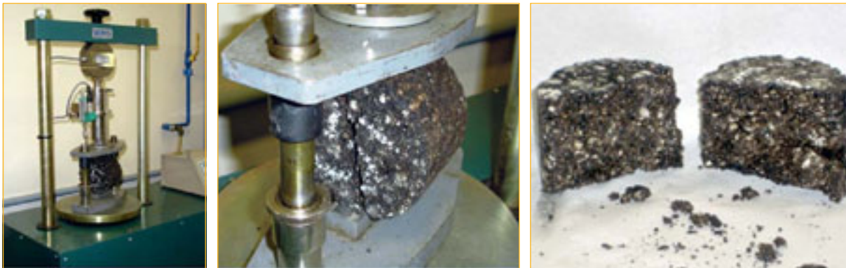
Figura 4 – Ensaio de resistência à tração por compressão diametral
