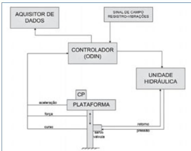
Figura 6 – Diagrama da malha de controle do ensaio
