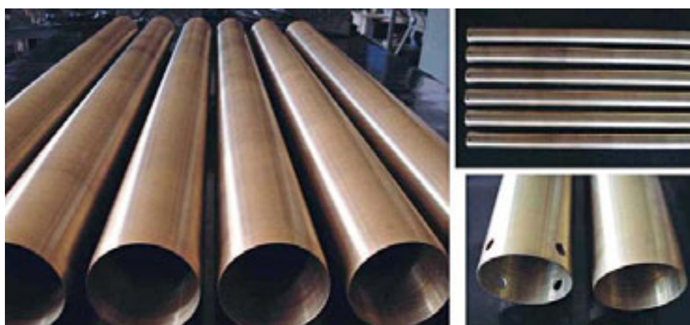
Figura 2 – Tubos amostradores de latão utilizados (Bertuol, 2009)
