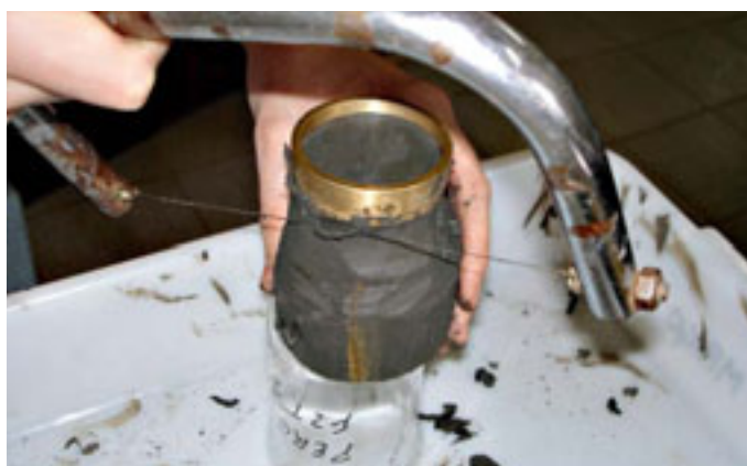
Figura 5. Moldagem dos corpos de prova para ensaios de adensamento
