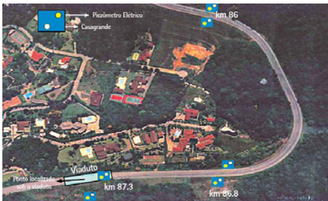
Figura 3 – Localização da instrumentação do entorno do km 87
